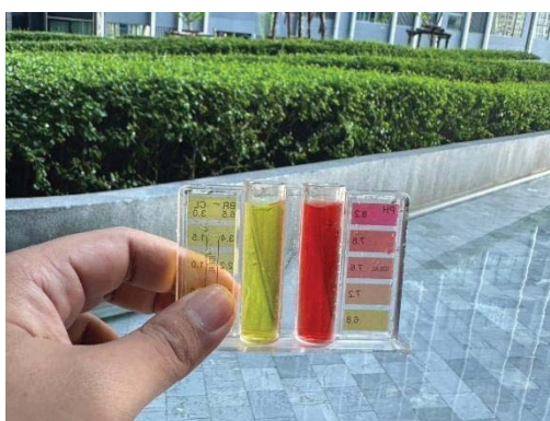
ภาพที่ 3.5.3-2 การตรวจวัด pH, Cl_2 สระว่ายน้ำ
